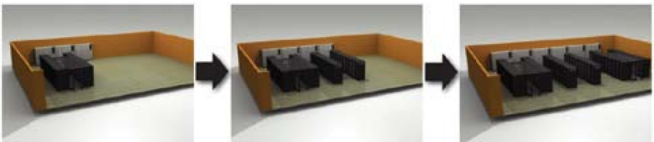
Při rozšiřování datacentra lze flexibilně zvětšovat a přeskupovat oblasti s běžným chlazením (do 5 kW/rack), řízeným tokem vzduchu (do 15 kW/rack) a aktivním systémem chlazení (do 30 kW/rack)
