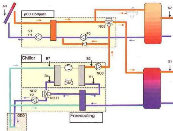
Řídící jednotka optimalizuje provozní efektivitu podle údajů z prostorových čidel teploty a vlhkosti, podle prioritních požadavků na teplou užitkovou vodu, dle možností částečného či úplného zpětného získání tepla.
